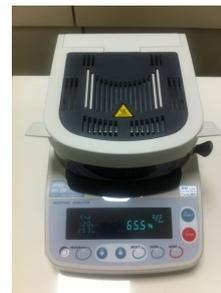
Fig. 2. Moisture analyzer (AND ML-50)
